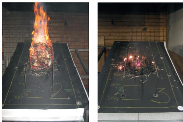
Les revêtements de toit combinés au PSE offrent une résistance éprouvée au feu volant.
