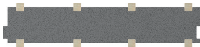
Les chevrons entrecoupés par l'isolant garantissent une isolation ininterrompue.
