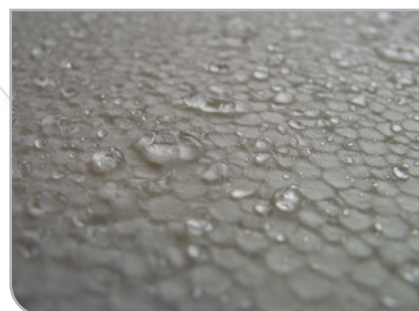
↑ EPS est insensible à l'humidité
